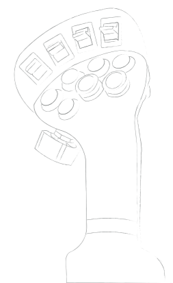
Le joystick PRINOTH et son extension pour des fonctions importantes
